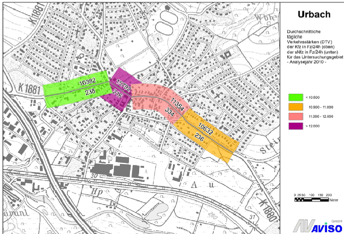
Bild 2.2: Jahresmittlere durchschnittliche Verkehrsstärken (DTV) für Kfz-gesamt und die schweren Nutzfahrzeuge (sNfz) im Untersuchungsgebiet Urbach
